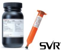
SVRは、ガラスの屈折率に近い光学特性と弾性を持つ樹脂で、ディスプレイモジュールとカバーガラスとの間（エアギャップ）に充填することにより、外光の反射とパネル内部の映像光の拡散を最小限に抑え、ディスプレイモジュール本来の高いコントラストをそのままに視認性の向上と薄型化を実現した材料として、スマートフォンではスタンダード品となっています。また、UV（紫外線）硬化時に粘着特性を発現する樹脂を新たに開発し、SVRの優れた光学特性と光学粘着フィルム（OCA）と同等の優れた作業性をあわせ持つハイブリッドSVRを製品化しました。すでに量産化を開始しており、スマートフォン市場及びタブレット市場でのさらなるシェア拡大を図っています。
