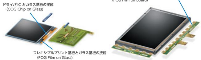
また、次世代のスマートフォンやタブレットPCなどの高精細ディスプレイのCOG実装に備え、ショート発生リスクの低減と最小バンプ間隔10μmのファインピッチ接続が可能な粒子整列タイプ、及び90℃低温圧着が可能なUV硬化型タイプを開発し、早期量産化を目指しています。
